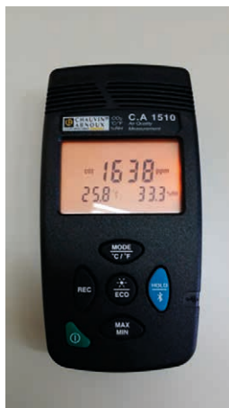
Figura 5.3. Medidor CA1510 de Chauvin Arnoux. Mide también Temperatura y Humedad.
